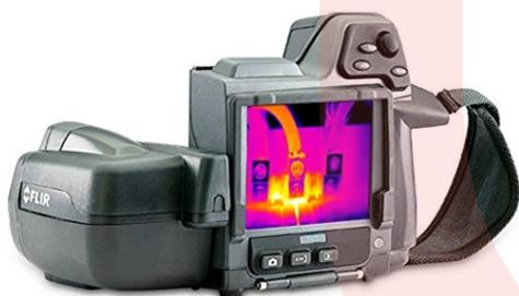
Analizzando la reazione del materiale al transitorio termico impostogli, la tecnica termografica consente di individuare tutte le principali forme di discontinuità materiale che possono generarsi durante il processo di fabbricazione di qualsiasi componente di un'imbarcazione (scafo, murate, coperta, componentistica, ecc.) e che possono avere importanti conseguenze sia a livello strutturale che estetico:
